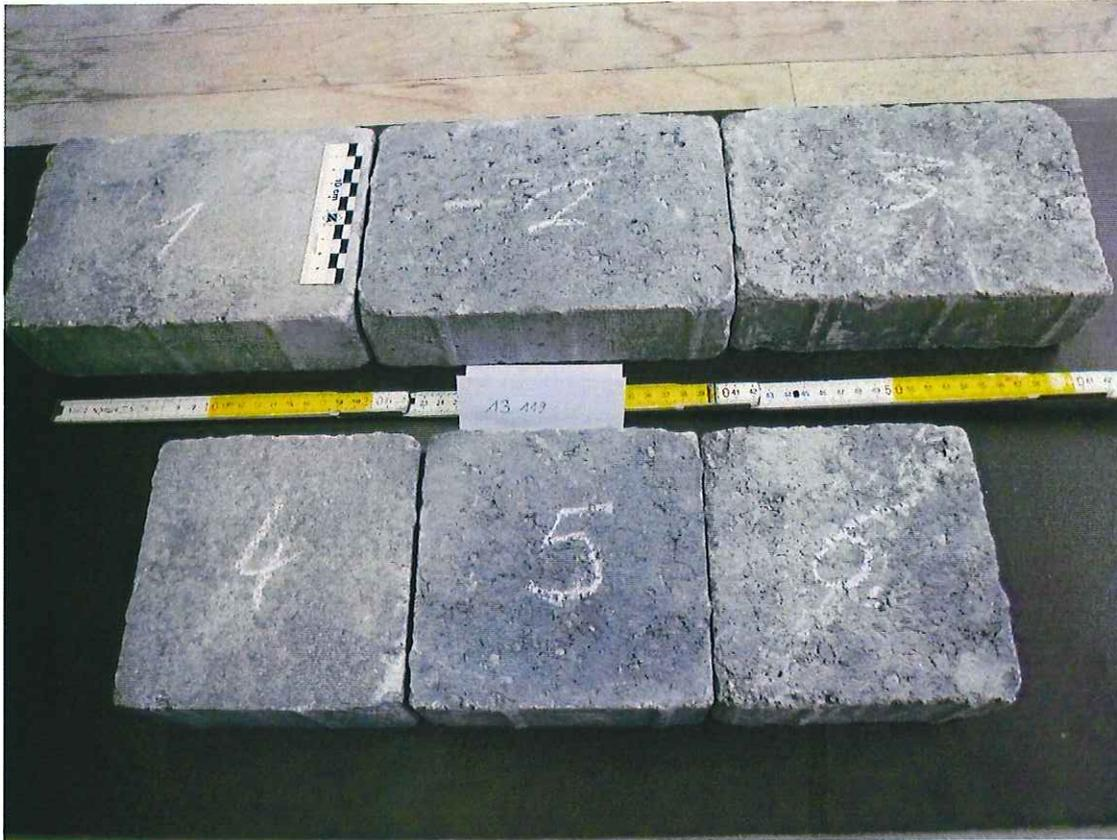
Bild 1: Pflastersteinsystem Karkea, Steinhöhe 60 mm
