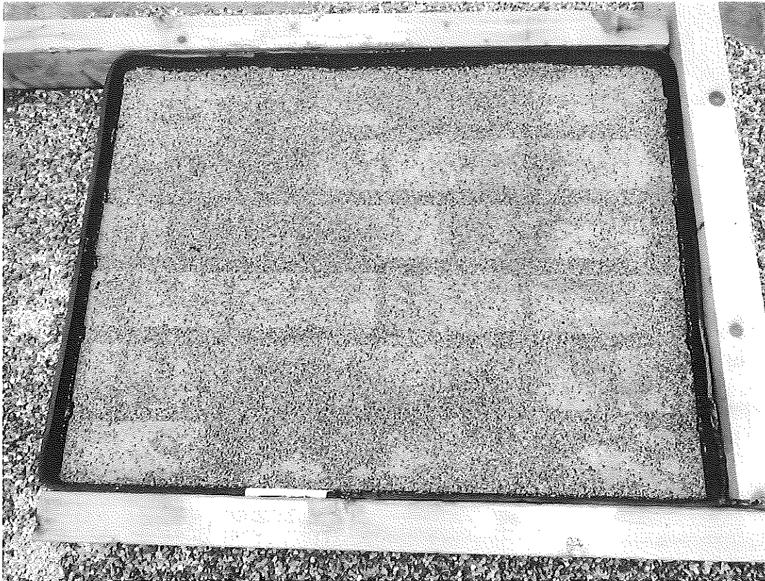
Bild 3: Versuchsfeld - Fugenbreite wurde mit 30 mm eingestellt
