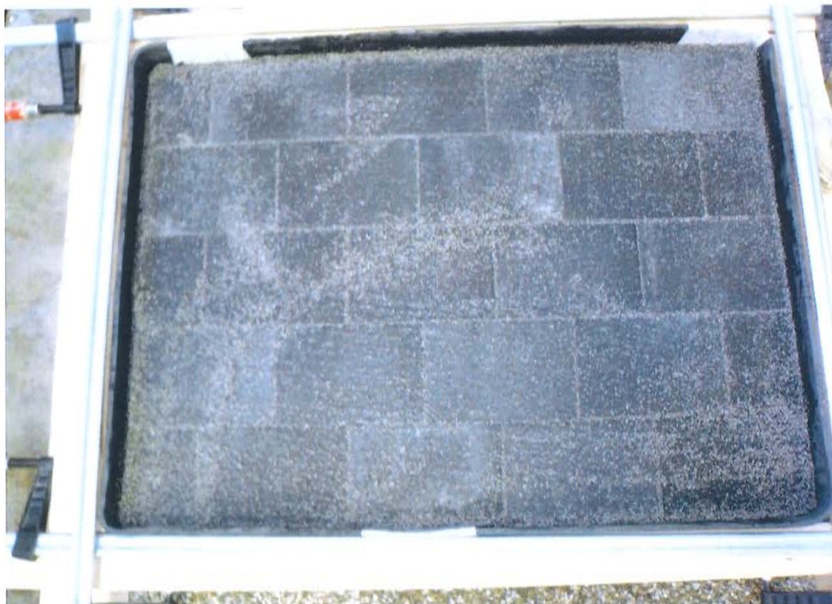
Bild 2: Vorgeschlagene Musterfläche des Betonpflastersystems „Melange Öko“ Steinhöhe 60 mm, verlegt im Läuferverband
