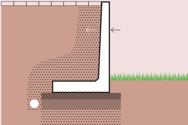
Beim Einbau ist darauf zu achten, dass die Stützwandelemente auf der Sichtseite mindestens um die Fußdicke unter der Geländeoberkante eingebunden werden.
